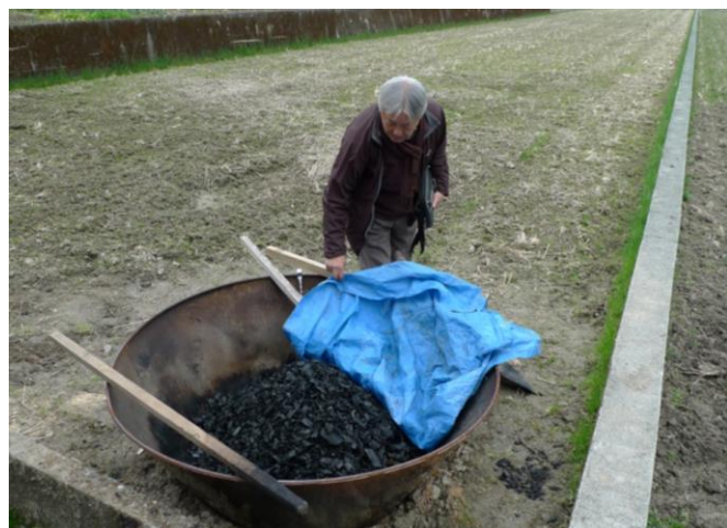
山下修氏の田んぼに設置されたEM整流炭焼き器（無煙炭化器）
